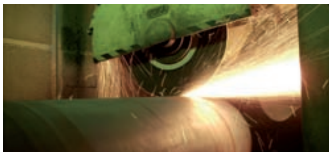
Рез с вращением заготовки
